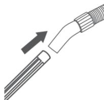
6. 将塑料延长管接到软管的另一端。
