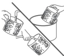
2. 用温和的肥皂水清洗泡沫滤网，然后用清水冲洗后再自然风干。
