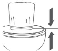
3. 过滤套已预先安装，与机头表面贴合。（此过滤套适用于干吸）
