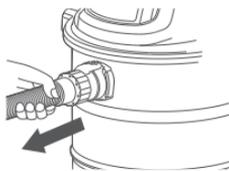
1. 确保电源线插头与插座断开。从吸尘器上取下软管。
