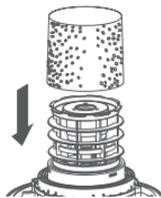
1. 松开搭扣，取下机头。小心地取下过滤套。
