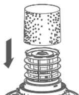
3. 将干净的泡沫滤网套入机头滤尘篮上，确保泡沫滤网和滤尘篮底部贴合。
