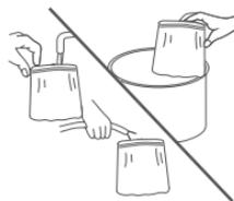
2. 轻拍过滤套，掸掉灰尘。或用温和和肥皂水清洗，然后用清水冲洗再自然风干。
