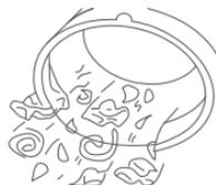
3. 清除尘桶和软管内的灰尘垃圾和碎屑。
