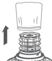
1. 确保电源线插头与插座断开。松开搭扣，取下机头。小心地取下过滤套。
