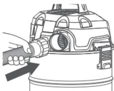
1. 确保电源线插头与插座断开。将软管带卡扣的一端接到尘桶的吹风口处。
