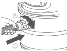
5. 将软管带卡扣的一端接到尘桶的吸口处，确保卡扣固定在正确的位置。
