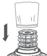
3. 将干净的过滤套套入机头滤尘篮上，确保过滤套和滤尘篮底部贴合。
