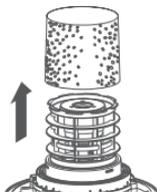
1. 确保电源线插头与插座断开。松开搭扣，取下机头。小心地取下泡沫滤网。
